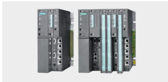
лей без демонтажа их внешних цепей и упрощающих выполнение операций подключения внешних цепей модулей. Механическое кодирование фронтальных соединителей исключает возможность возникновения ошибок при замене модулей.
