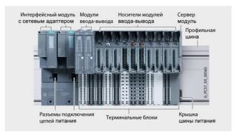
Помимо возможности резервирования интерфейсных модулей станции SIMATIC ET 200SP HA, также модули ввода/вывода можно устанавливать с резервированием каналов. Это реализуется за счет применения терминального модуля с встроенным резервированием входов/выходов.
