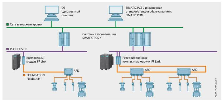
Сети полевого уровня PROFIBUS PA и FOUNDATION Fieldbus H1 (FF H1) соответствуют требованиям международного стандарта IEC 61158-2 и используют для своей работы метод МВР (Manchester Coded; Bus Powered). Обмен данными со скоростью 31.25 кбит/с и питание узлов сети осуществляется через один экранированный двухпроводной кабель.
