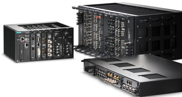
L3 коммутаторы RUGGEDCOM для монтажа в 19" стойку
